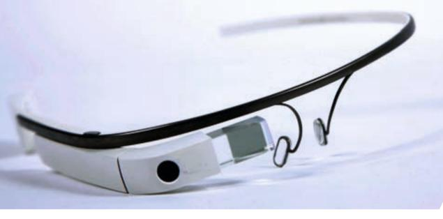
Datenbrillen sind eine wichtige Komponente im Forschungsprojekt »SmARPro«, das darauf zielt, den Arbeitsalltag von Menschen im industriellen oder logistischen Umfeld zu erleichtern. Anhand eines Verpackungsdemonstrators zeigt das Fraunhofer IML, wie »Augmented Reality« (AR) die Abläufe im Bereich der Kommissionierung und Verpackung unterstützt und vereinfacht.
